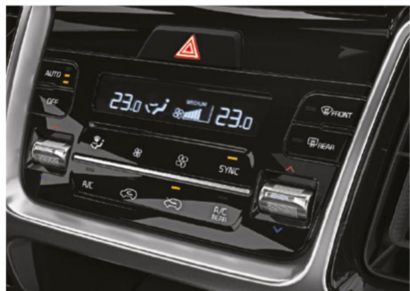
Sistema de aire acondicionado automático bi-zona y sistema de aire acondicionado trasero en la tercera fila
